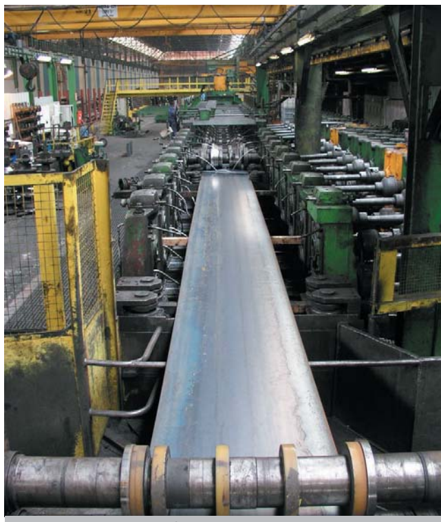
Fot. 3. Przeciąganie przez walce
