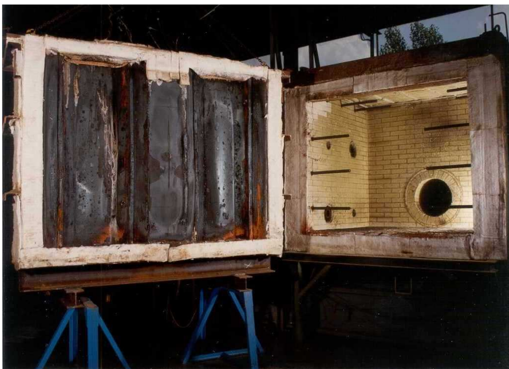
Rys. 4. Komora badawcza do symulowania warunków występujących w trakcie pożaru [3]
