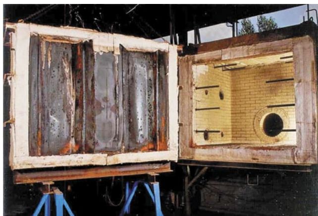
Fot. 2. Specjalna komora do badania zależności między temperaturą gazów a temperaturą stali grodzicy [2]
